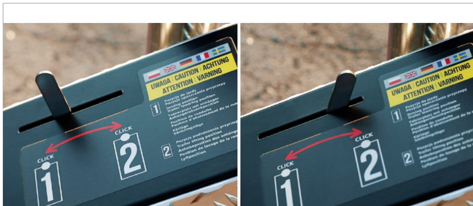
Przekładnia zębata: POZYCJA 1 - jazda / opuszczanie, POZYCJA 2 - podnoszenie
